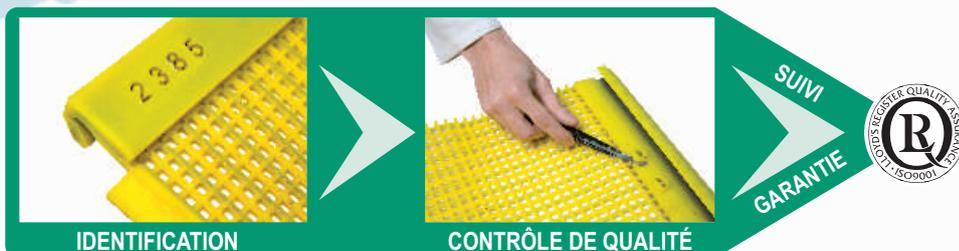
Les mailles INE-FLOW® sont soumises à un contrôle de qualité très strict. Beaucoup sont fabriquées avec deux éprouvettes fixées sur elles-mêmes; l'une est soumise à des tests dans un abrasimètre, et l'autre tient le rôle permanent de garantie de la qualité de la maille.
